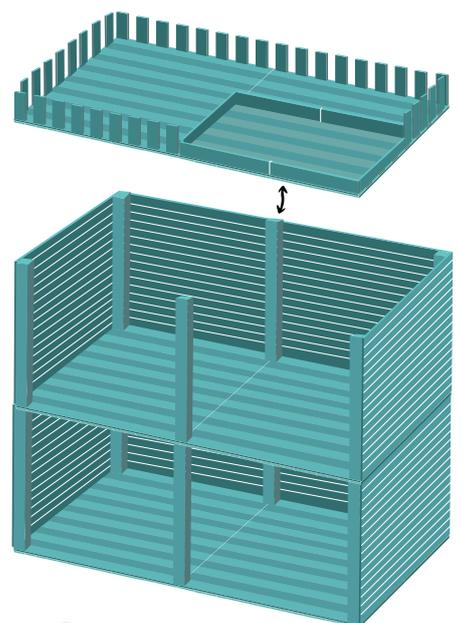
**6** Im letzten Schritt müssen nur noch alle Böden zusammengeklebt werden und schon ist das Haus fertig.
